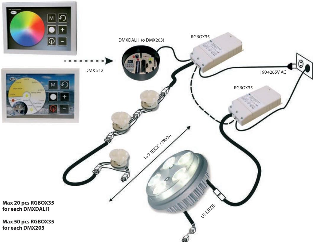
ITALY Sistema DMX - Questo schema illustra come realizzare sistemi di illuminazione di potenza, a colore variabile - Utilizzando l'alimentatore RGBBox35 è possibile collegare fino a 9 spot TRIOColor o 2x U115RGB - In alternativa agli spot TRIOColor si possono utilizzare gli spot TRIOAmbiente.
